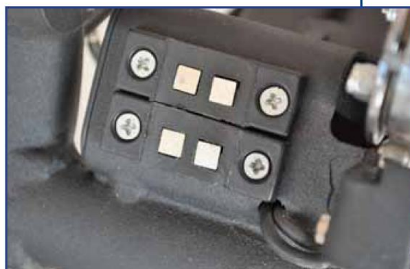
33 Styki elektryczne na spodzie wspornika
