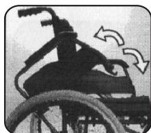
Odchylenie podłokietnika - pociągnij za bolec, aby odchylić podłokietnik. Opuszczenie podłokietnika - przesuń podłokietnik do odpowiedniej pozycji. Upewnij się, że bolec jest odpowiednio umieszczony z przodu podstawy.
