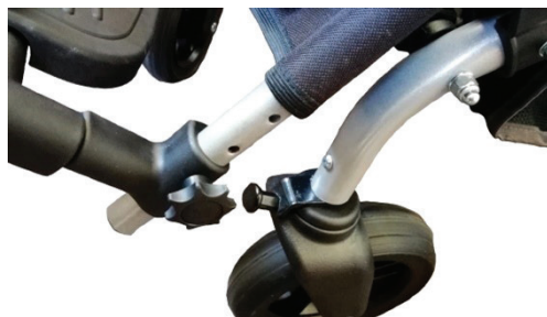
Ryc. 24. Pokrętło regulacji długości podnóżka
