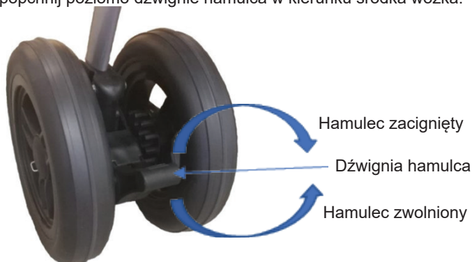
Ryc 21A. Mechanizm dźwigni hamulca kół tylnych (Umbrella 1 i 2)
