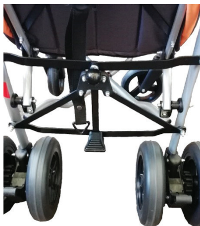
Ryc. 10. Tylna blokada wózka zwolniona
