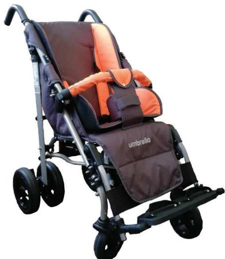
Ryc. 16. Zamontowany klin abdukcyjny, pas tapicerki i stolik
