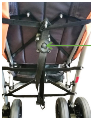
Ryc. 25. Pasy regulacji oparcia
