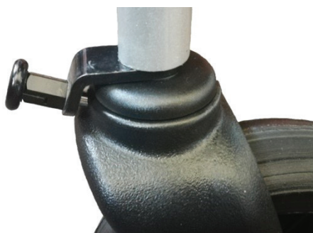
Ryc. 23. Blokada ruchu skrętnego kół
